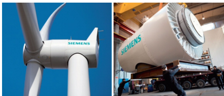
Рис.6 – Безредукторная технология ВЭУ немецкой компании «Siemens»
