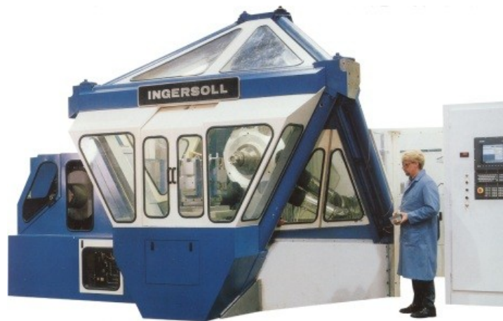
Рис. 3. Широкоуниверсальный обрабатывающий центр Octahedral Hexapod HON-600 фирмы Ingersoll
