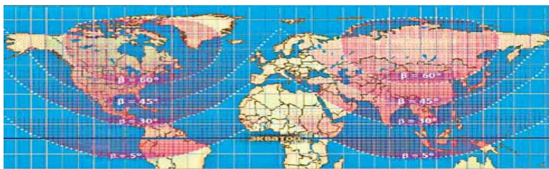
Рис. 1. Зона обслуживания КА на орбите типа «Молния»
