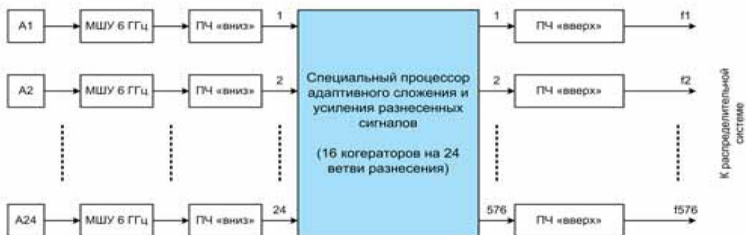
Рис. 3. Структурная схема приемного комплекса С-диапазона
