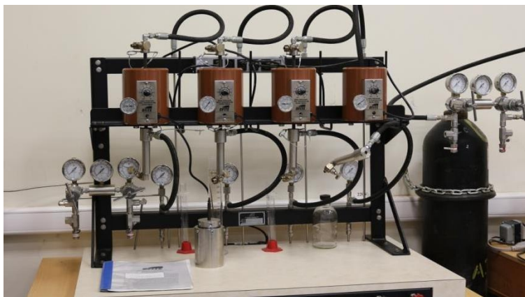
Высокотемпературный пресс-фильтр высокого давления
