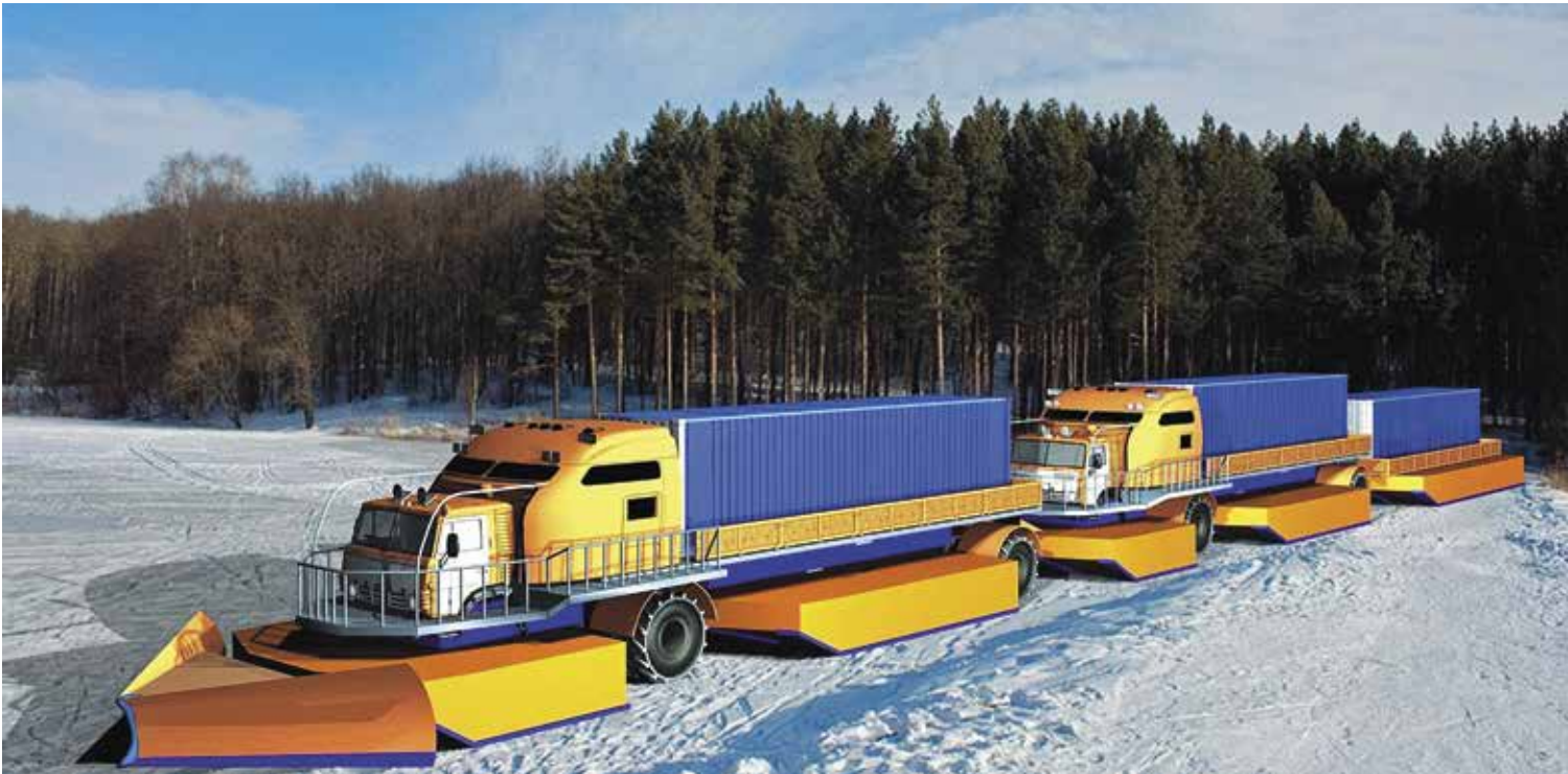
Магистральный контейнеровоз для передвижения по руслам малых и больших рек и снего-ледяным дорогам
