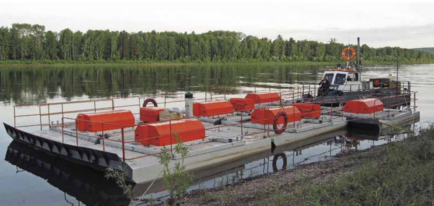
Сейсморазведочный импульсный излучатель «Енисей СЭМ-150», установленный на Ангаре
