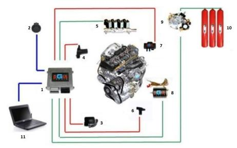
Рис. 1. Состав оборудования системы газового питания 1 — электронный блок управления; 2 — переключатель для топлива; 3 — датчик положения дроссельной заслонки; 4 — датчик положения распредвала; 5 — форсунки; 6 — датчик положения коленчатого вала; 7 — MAP датчик (датчик абсолютного давления воздуха); 8 — шаговый двигатель; 9 — газовый редуктор; 10 — баллон высокого давления для газа
