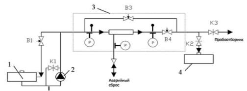
Аппаратурно-технологическая схема установки №2: 1 — исходная емкость, 2 — насос, 3 — рабочий участок, 4 — приемная емкость (резервуарный парк)
