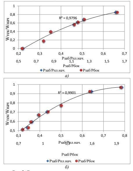
Рис. 2. Динамика раскрытости естественных трещин при снижении забойного давления: скв.429 (а) и скв.430 (б) Озерного месторождения
