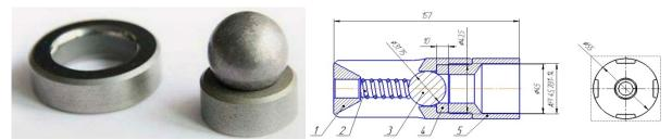
Рис. 2. Конструкция клапанного узла
