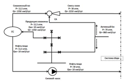
Рис. 1. Модульно-блочная насосно-эжекторная установка снижения устьевого давления
