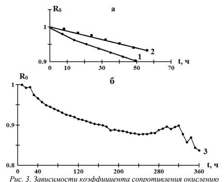
от времени испытания синтетических моторных масел:
