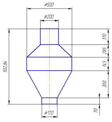
Рис. 1. Размеры реактора
