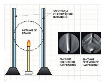
Рис. 5. Воздействие электромагнитных волн на пламя
