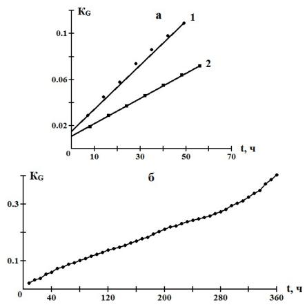
$Puc.\ 2.\ 3$ ависимости коэффициента испаряемости от времени окисления синтетических моторных масел: 1- «Mobil Super 3000» 5W-40 SJ/SL/SK/CF; 2- «Mobil Super New Life» 0W-40 SJ/SL/CF; 3- «ZIC XG» 5W-40 SL/CF
