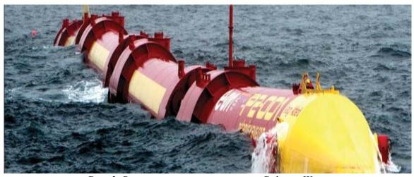
Рис. 3. Волновой электрогенератор Pelamis Wave
