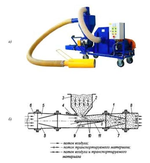
Рис. 4. Пневматическая установка для транспортировки сыпучих материалов: а – внешний вид; б – принцип действия
