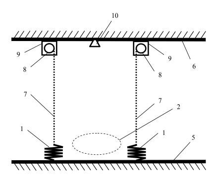
Рис. 2. Поперечное сечение (в вертикальной плоскости) схемы взаимного расположения противопожарной преграды, находящейся в сложенном состоянии при отсутствии очага возгорания
