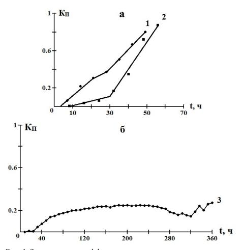
Puc. 1. Зависимость коэффициента поглощения светового потока от времени окисления синтетических моторных масел:
