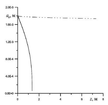
Рис. 2. Зависимость радиуса газового пузырька от вертикальной координаты
