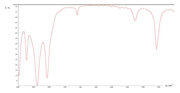
Рис. 1. ИК-спектр пропускания полипропилена
