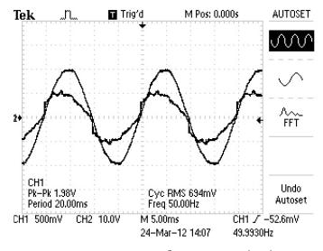
Рис. 5. Осциллограмма тока потребления светодиодного светильника
