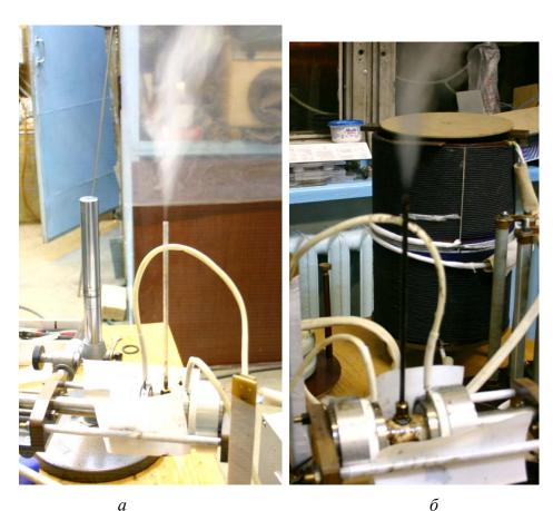
Рис. 5. Движение паро-нефтяной эмульсии по капилляру при воздействии электрического поля: 5а — в начальный момент времени, с выделением белого пара; 5б — с выделением черного пара
