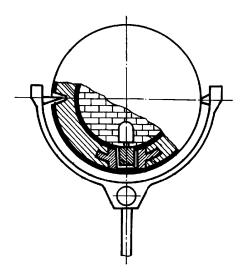
Рис. 2. Шаровой контейнер с приспособлением для его подкатывания
