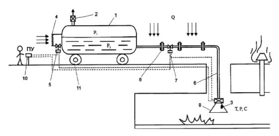
Рис. 2. Криогенная азотная установка для тушения пожара в замкнутых объектах
