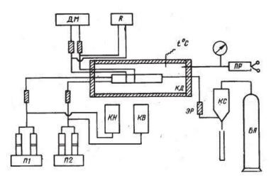
Рис. 1. Принципиальная схема установки для определения относительных фазовых проницаемостей при установившемся течении нефти и воды
