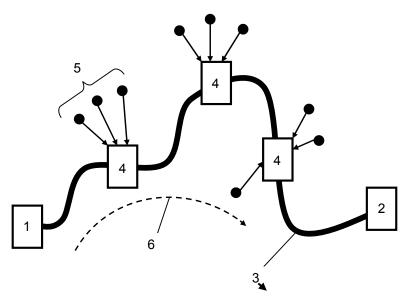
Рис. 5. Функциональная схема системы пневмотранспорта: 1 — исходный пункт; 2 —конечный пункт; 3 — пневматическая линия; 4 — перегрузочные пункты; 5 — ветроэнергетические установки; 6 — направление транспортировки грузов
