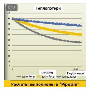
Рис. 1. График изменения теплоты для скважин до 1000 м
