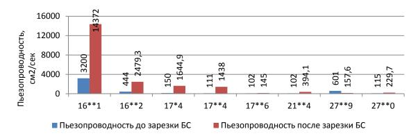
Рис. 7. Пьезопроводность до и после "зарезки" БС
