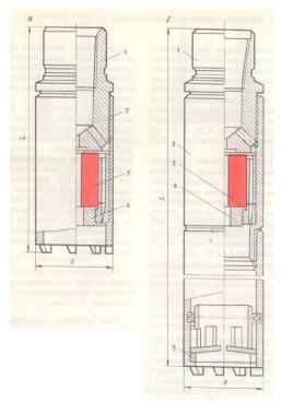
Рис. 1. Фрезер ловитель магнитный: а – типа ФМ; б – типа ФМЗ. 1-переводник, 2-корпус, 3-магнитная система, 4-нижний полюс магнита, 5-захватный узел
