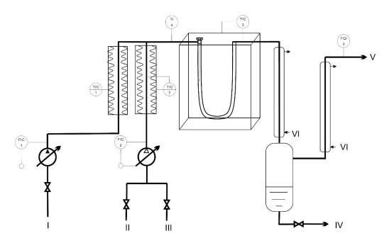
Рису. 1. Схема лабораторной установки термического пиролиза
