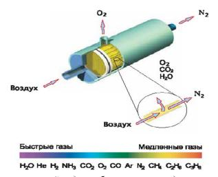
Рис. 3. Принципиальный вид мембранного цилиндрического картриджа
