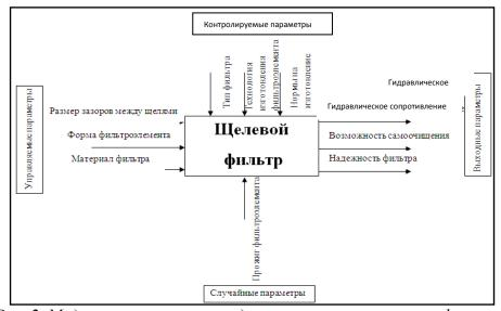
Рис. 2. Модель «черного ящика» для щелевого скважинного фильтра
