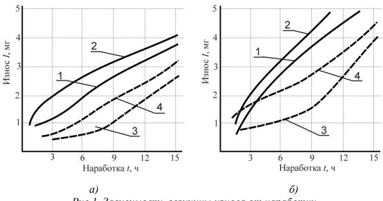
Рис.1. Зависимость величины износа от наработки для пластичной смазки Солидол C (a) и ЦИАТИМ-203 (б): 1- без добавки (0,5 кH); 2- без добавки (2 кH); 3- с добавкой УДПАГ (0,5 кH); 4- с добавкой УДПАГ (2 кH).
