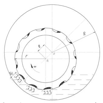
Рис. 2. Схема работы подшинника с регулярным микрорельефом ячеистого типа
