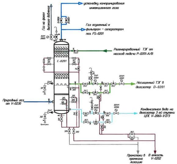
Рис. 1. Технологическая схема блока абсорбера
