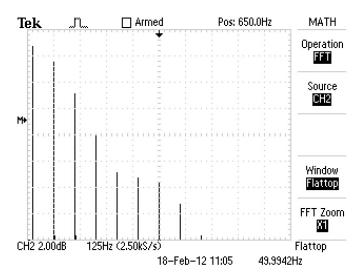
Рис. 4. Анализ потребляемого тока светодиодных светильников в спектральных координатах
