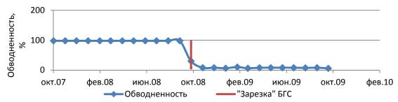
Рис. 2. Изменение обводненности в скважине  $2^{***}$ д до и после "зарезки" БГС
