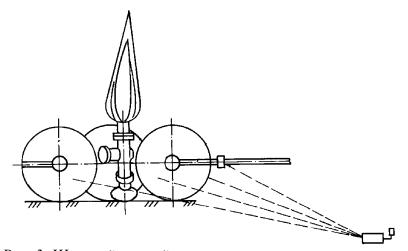
Рис. 3. Шаровой контейнер при установке его у скважины
