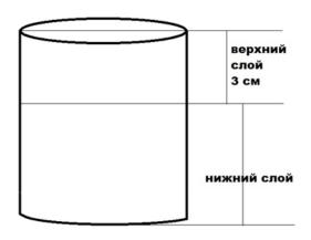
Рис. 3. Схема разделения пробы почвы
