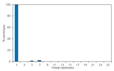
Рис. 2. Полностью исправленная нагрузка ПК-типа
