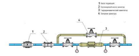
По аппаратурно-технологической схеме первым стоит насос по выходу из ГНПС, потом в трубопровод добавляется присадка через плужерный насос дозатор через форсунку при температуре 50 °C, далее стоит гидродинамический кавитатор и после всего на некотором расстоянии ре-
