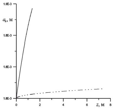
Рис. 3. Зависимость радиуса гидратной частицы от вертикальной координаты
