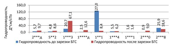
Рис. 4. Гидропроводность до и после зарезки БГС
