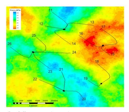
Puc. 2. Карта распределения давления сжатия трещин. Красный цвет – высокая раскрытость трещин, синий – низкая раскрытость
