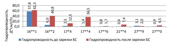
Рис. 3. Гидропроводность до и после "зарезки" БС
