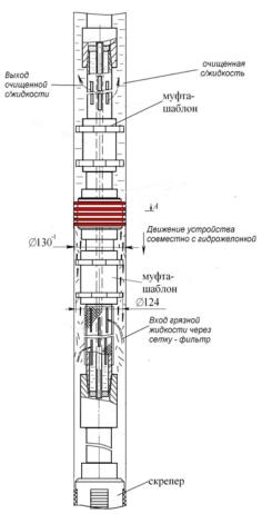
Рис. 2. Очистка экс/колонны и фильтрация скважинной жидкости
