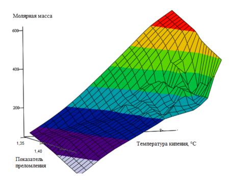
Рис. 1. Зависимость молярной массы от показателя преломления и температуры кипения
