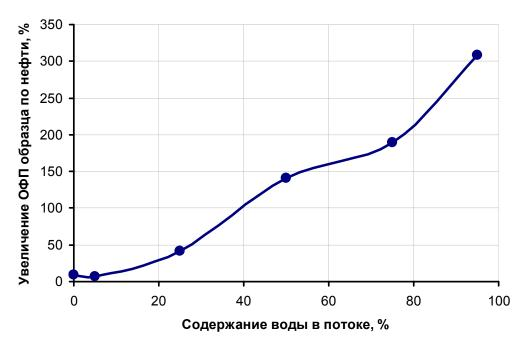
Рис. 4. Зависимость увеличения ОФП образца по нефти от содержания воды в потоке
