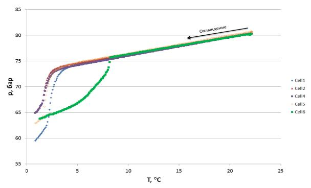
Рис. 1. Результаты исследования ингибирующих свойств реагента Luvicap 55W при начальном давлении в ячейках 80 бар, гидратообразующий газ — метан; в ячейках № 1-5 жидкая фаза 0,5 % раствор ингибитора, в ячейке № 6 — дистиллированная вода без ингибитора
