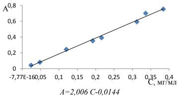
Рис. 2. Градуировочный график для определения концентрации урана
