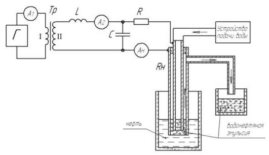
Рис. 4. Установка для демонстрации возможности получения водонефтяной эмульсии и её транспортировки
