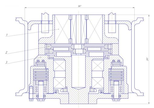
Рис. 1 — Разработанный волновой вариатор, установленный в мотор-колесо: 1 — электромотор; 2 — эксцентриковый редуктор; 3 — кожух
