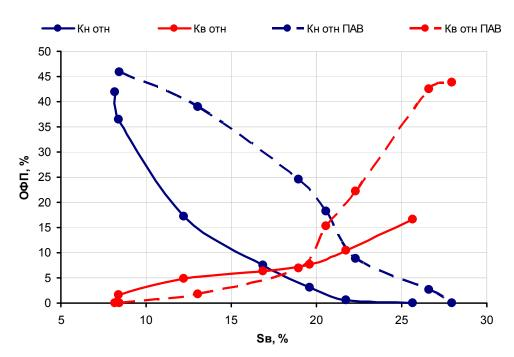
Рис. 3. График зависимости ОФП исследуемого образца от величины водонасыщенности с добавлением ПАВ в модель пластовой воды и без него
