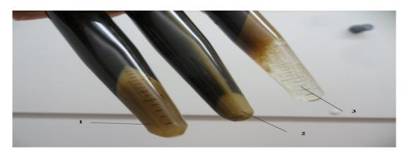
Рис. 1. Результаты центрифугирования нефти: 1-проба нефти Б; 2-проба нефти А, 3-проба нефти В [4].
