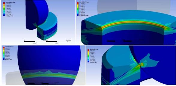
Рис. 3. Контактные напряжения в клапанном механизме
