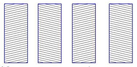
Рис. 3. Схема кулачков с концентрической резьбой разной направленности
