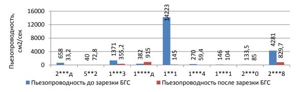
Рис. 8. Пьезопроводность до и после "зарезки" БГС
