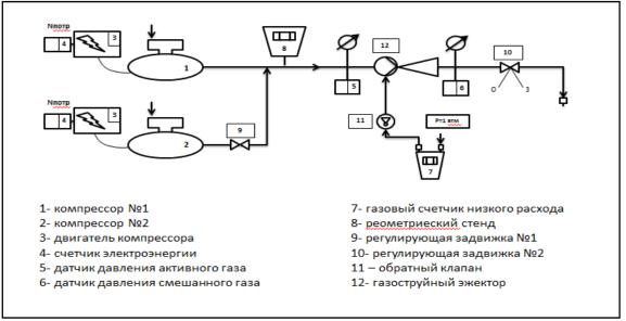
Рис. 2. Схема экспериментального стенда для испытаний газоструйного эжектора
