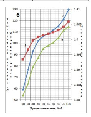
Рис. 2. Кривые распределения молярной массы (1), температуры кипения (2) и показателя преломления (3) бензинов: каталитического риформинга (а) и сернокислотного алкилирования (б)
