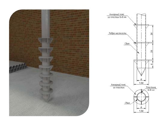
Рис. 1. Внешний 3D види чертежная схема сваи «AntiFrost»
