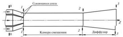
Рис. 3. Принципиальная схема газоструйного эжектора
