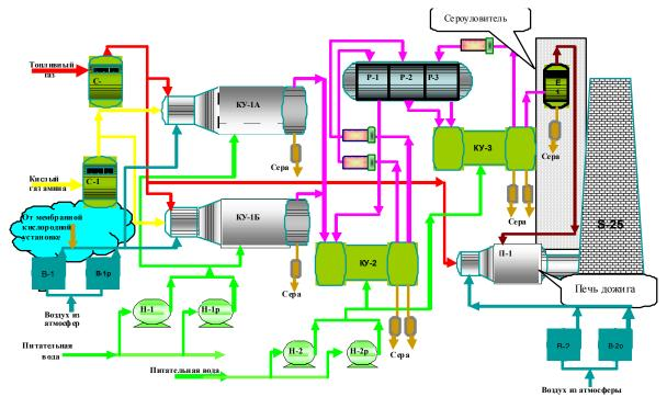
Рис. 1. Принципиальная схема установки с обогащением воздуха кислородом
