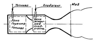
Рис. 1. Формирование сверхзвуковой струи газа с помощью сопла Лаваля
