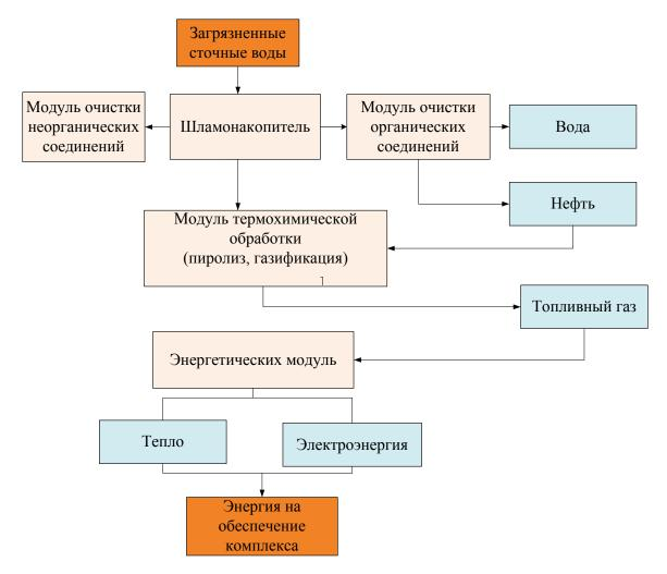
Рис. 1. Принципиальная схема автономного комплекса для очистки сточных вод нефтегазовых промыслов
