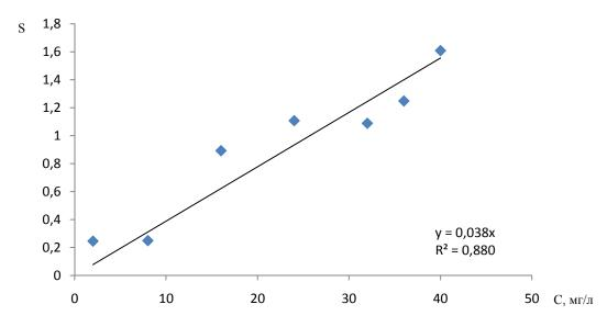
Рис. 3. Градуировочный график для определения НП в воде методом твердофазной ИК-спектроскопии
