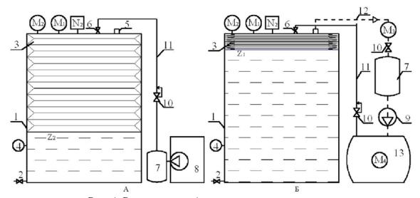
Рис. 4. Резервуары с «дышащей» газовой камерой:
