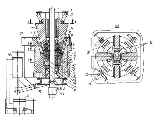
Рис. 1. Схема устройства для захвата трубы в роторе
