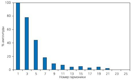
Рис. 1. Некомпенсированный спектр нагрузок ПК-типа
