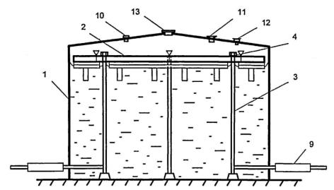
Рис. 5. Вертикальный резервуар с плавающей крышкой или понтоном: 1 — резервуар; 2 — плавающая крышка или понтон; 3 — направляющая стойка; 4 — заглушка; 9 — пускозапорное устройство; 10 — дыхательный клапан; 11 — световой люк; 12 — замерной люк; 13 — вентиляционный патрубок
