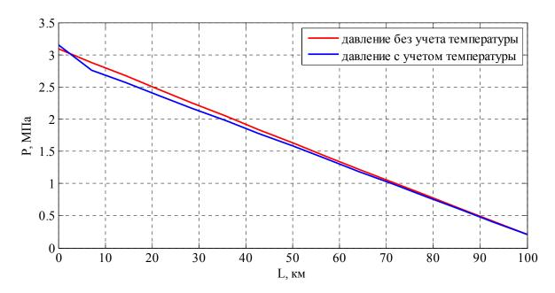
Рис. 1. Зависимости давлений от координаты сечения
