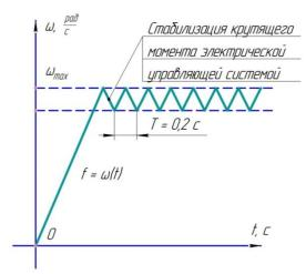
Рис. 2. Зависимость угловой скорости вращения разработанного волнового вариатора от времени
