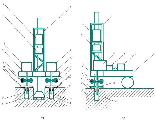
Рис. 1. Анкерная буровая установка с анкерами вакуумного типа: a- общий вид; b- вид с боку
