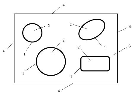
Рис. 1. Противопожарные преграды, расположенные в виде рукавов вокруг пожароопасных зон внутри производственного помещения
