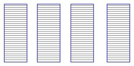
Рис. 2. Схема кулачков с концентрическими нарезками
