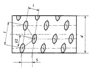
Рис. 3. Общий вид и геометрические характеристики регулярного ячеистого микрорельефа
