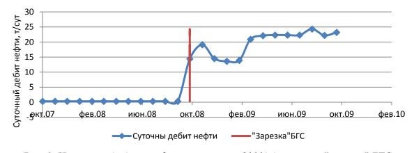
Рис. 1. Изменение дебита нефти в скважине 2\*\*\*д до и после "зарезки" БГС
