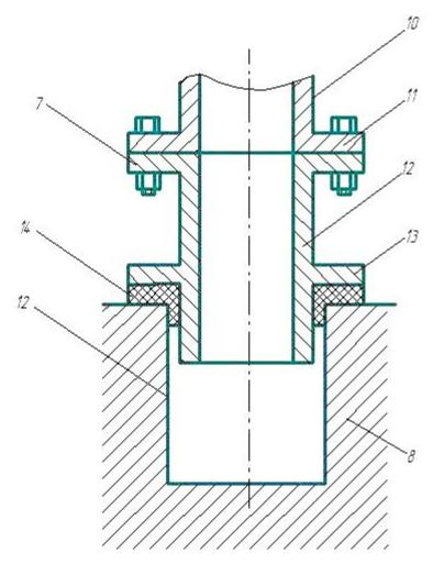
Рис. 2 Фрагмент анкерного устройства вакуумного типа, продольный разрез
