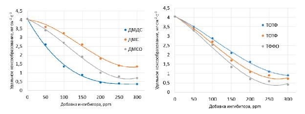
Рис. 2. Зависимости удельного коксообразования от дозировки ингибиторов
