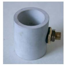
Рис. 6. Внешний вид камеры, заполняемой исследуемым образиом
