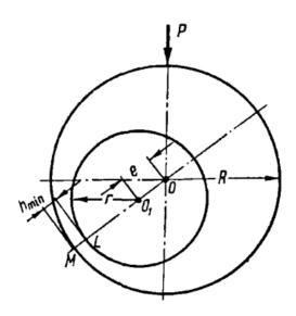
Рис. 1. Схема работы подшипника скольжения
