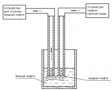
Рис. 3. Разжижение нефти путем закачки горячей воды
