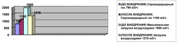
Рис. 4. Производственные показатели до и после внедрения установки
