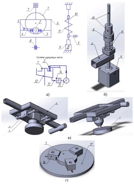
Рис. 1. Элементы конструкции машины трения а) кинематическая схема дисковой машины для исследования трения; б) модель узла нагружения; в) модель узла трения; г) модель держателя диска-образца.
