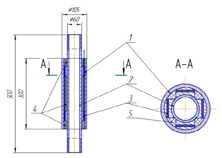
Рис. 1. Конструкция стенда для экспериментальных исследований модели термоизолированного направления
