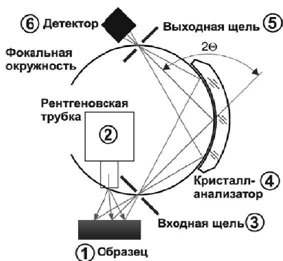
Рис. 4. Принципиальная рентгенооптическая схема: 1 – исследуемый образец; 2 – рентгеновская трубка; 3 – входная щель; 4 – кристалл-анализатор; 5 – приемная (выходная) щель; 6 – блок детектирования
