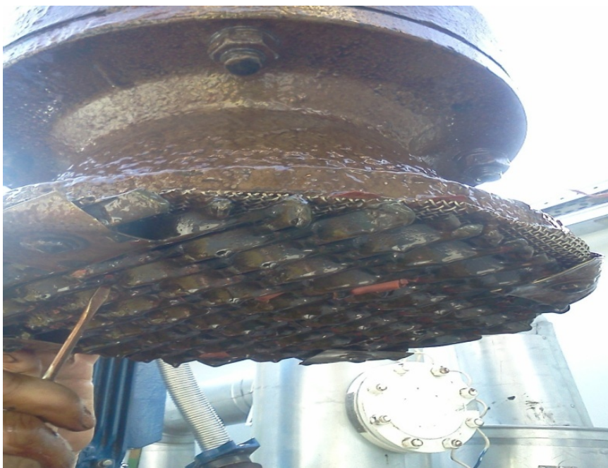
Рис. 2. Фильтр дренажной емкости с двухступенчатым фильтрующим элементом
