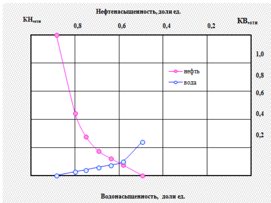
Рис. 2. График функций относительных фазовых проницаемостей для нефти и воды на образце керна одного из исследованных месторождений
