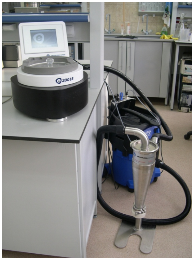
Рис. 2. Фотография установки воздушно-ситового просеивания ALPINE e200 LS
