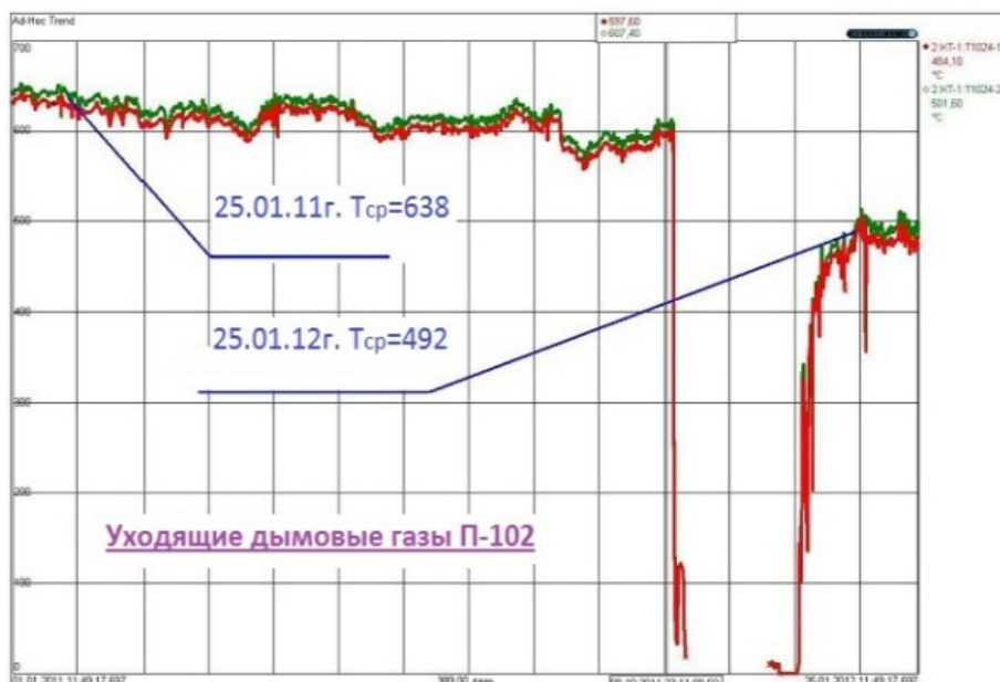
Рис. 7. Тренд КПД печи до и после нанесения энергоэффективного покрытия
