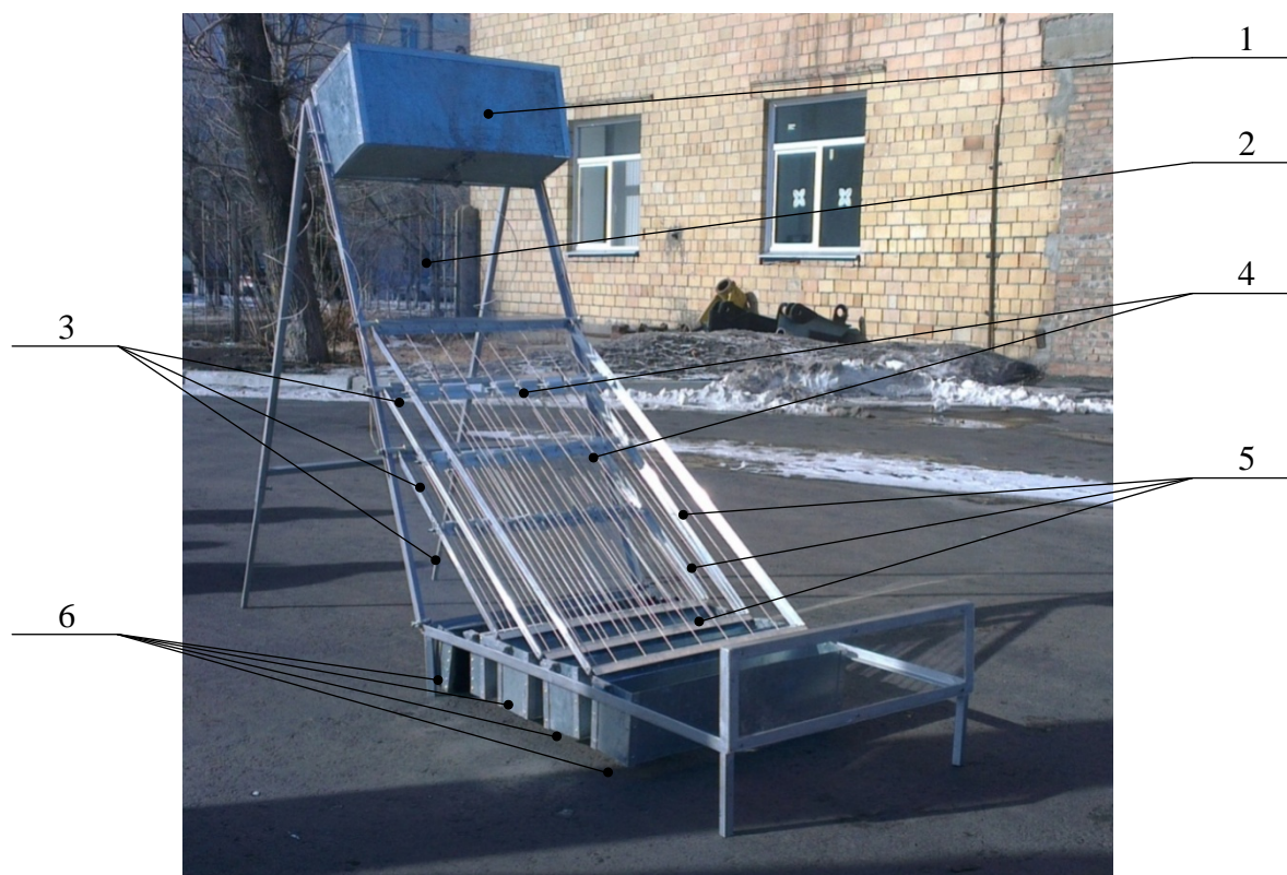
Рис. 1. Действующая модель струнного грохота: 1 - загрузочный бункер, 2 передняя стенка (из оргстекла), 3 - просеивающие секции, 4 - ворошители, 5 - струны просеивающих секций, 6 - приемные бункеры
