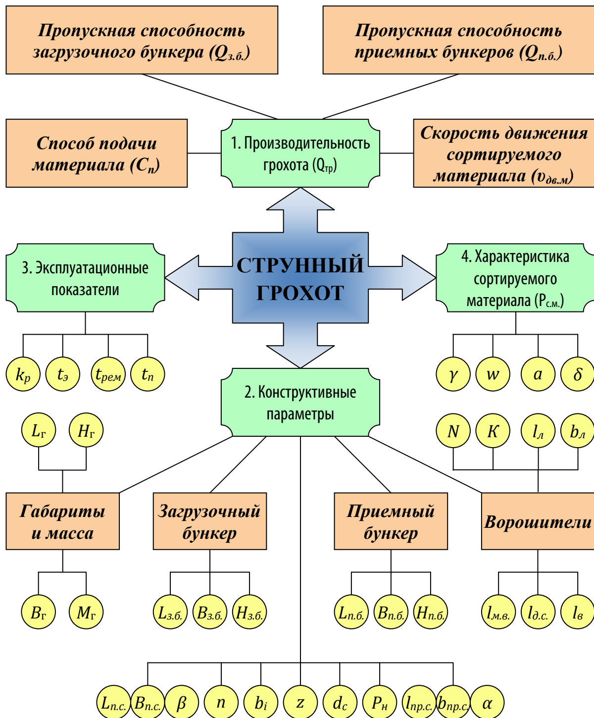
Рис. 2. Схема параметров, влияющих на работу струнного грохота: Q_{тр} – требуемая производительность, м^3/ч ; Q_{з.б.} , Q_{п.б.} – пропускные способности загрузочного и приемных бункеров, м^3/ч ; C_n – способ подачи сортируемого материала; v_{дв.м} – скорость движения горной массы по рабочей поверхности грохота, м/с ; P_{с.м.} – характеристика сортируемого материала ( \gamma – плотность, кг/м^3 ; w – влажность, %; a – гранулометрический состав, мм ; \delta – абразивность, мг ; k_p – коэффициент работы грохота; t_э – время эксплуатации, ч ; t_p – время, затрачиваемое на ремонт, ч ; t_n – время простоев, ч ; габариты грохота ( L_э – длина, B_э – ширина, H_э – высота грохота), мм ; M_э – масса грохота, кг ; L_{з.б.} , L_{п.б.} – длина загрузочного и приемных бункеров, мм ; B_{з.б.} , B_{п.б.} – ши-
