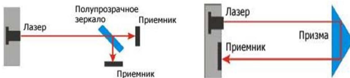
Рисунок 5. Системы с одним лазером и одним или двумя приемниками
