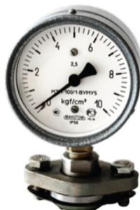
*Рисунок 9. Манометр для пищевой промышленности*
