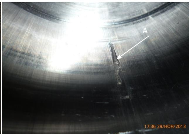
*Рисунок 3. Рабочая поверхность цилиндра захвата. А образование «задира» рабочей поверхности гильзы цилиндра.*
