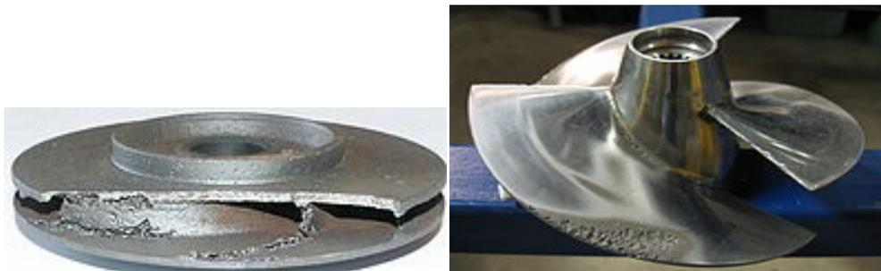
*Рис. 2. Повреждения, наносимые эффектом кавитации на части насоса (а), гребном винте (б)*
