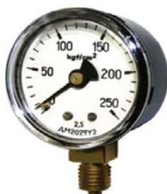
*Рисунок 2 . Технический маномер*
