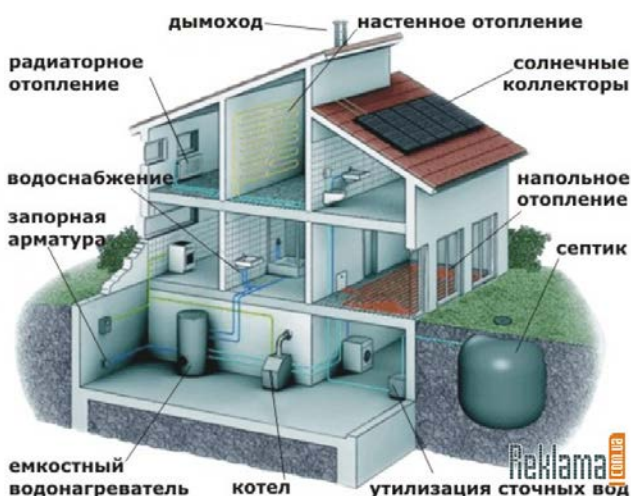
Рис.2 . Монтаж инженерных систем теплоснабжения, электроснабжения, водоснабжения и водоотведения
