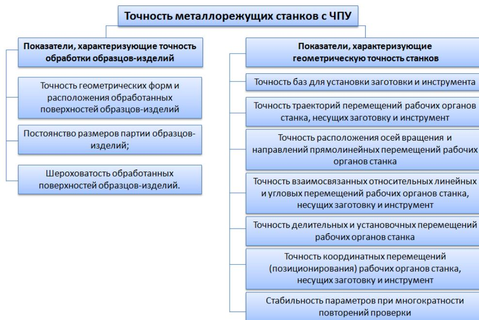
Рисунок 2. Составляющие точности металлорежущих станков
