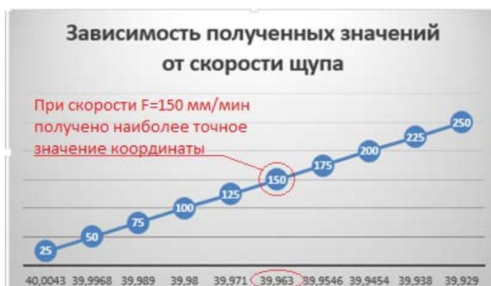
Рисунок 3. Зависимость значения координаты точки при измерении от скорости подачи шпула
