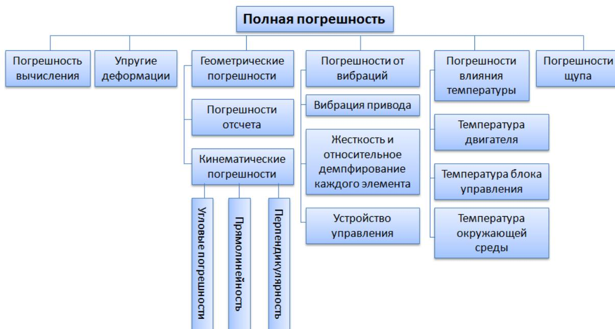
Рисунок 1. Составляющие погрешности координатных измерений
