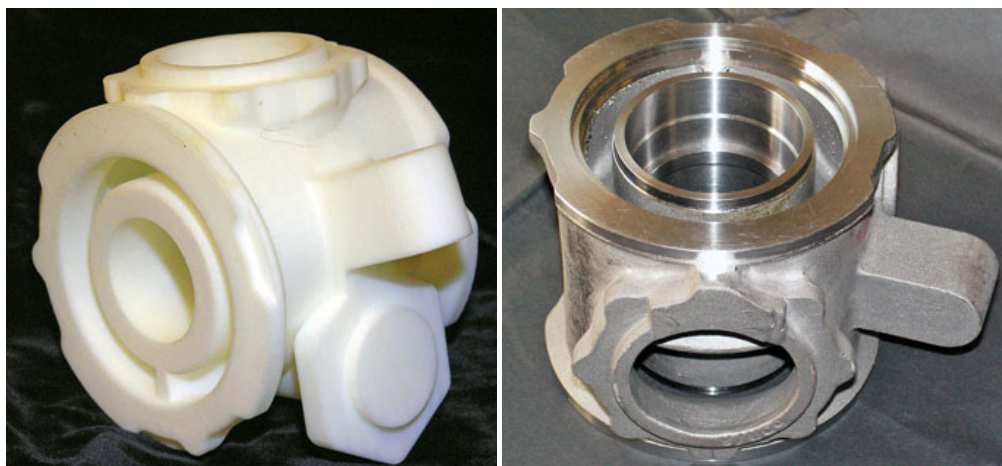
Рис. 2 Литейная форма и готовая деталь
