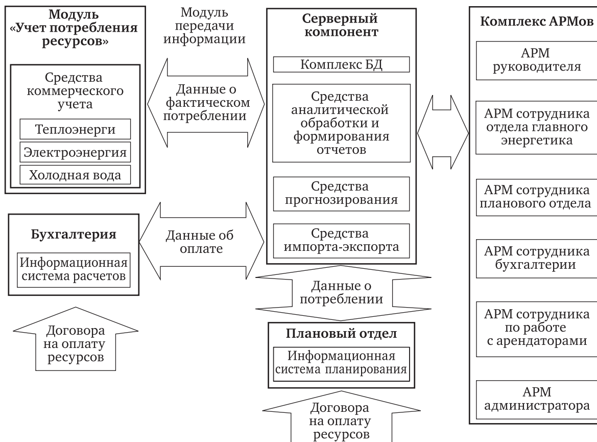
Рис. 1. Архитектура программно-технического комплекса АИИС СФУ
