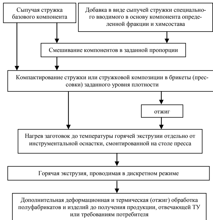
Рисунок – Общая технологическая схема получения продукции на основе переработки стружки цветных металлов и сплавов.
